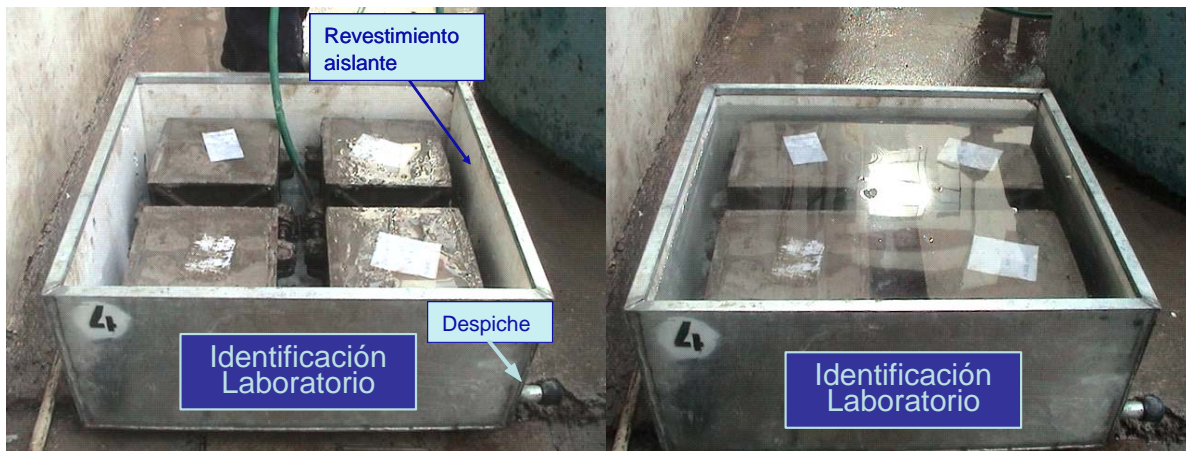
Figura 6. Curado inicial por inmersión de probetas en Chile
