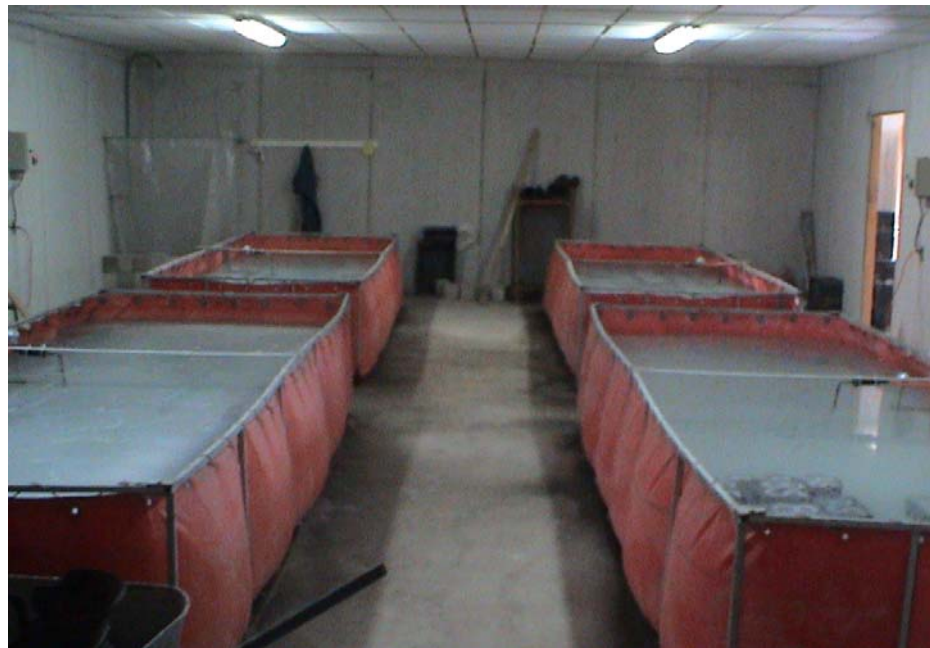
Figura 10. Curado en piscinas en Laboratorio.
