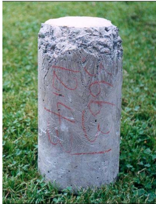
Figura 4. Probeta que sufrió congelamiento.
